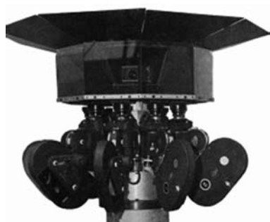
Установка из 16-мм кинокамер «Arriflex» для съёмки кругорамного фильма по 9-ти камерной системе «Циркарама»
