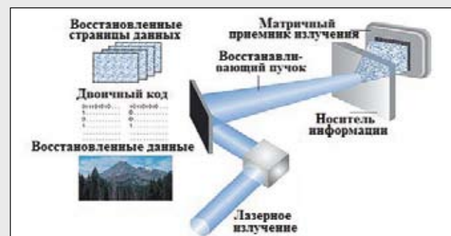
Рис. 2. Схема считывания информации в системе оптико-голографической памяти
