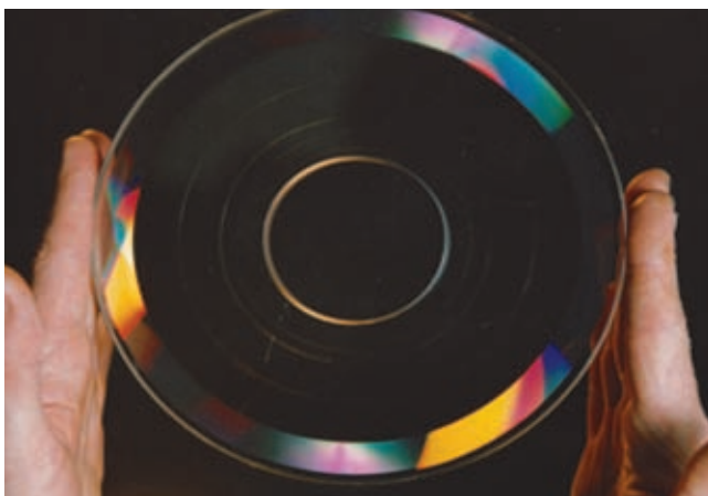
Рис. 2. Фотография радиального голографического диска со средним диаметром штриховой дорожки \Phi = 180 мм и N = 518400 штрихов/2 \pi
