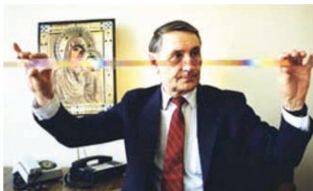
Рис. 1. Фотография линейной голографической дифракционной решётки ЛГДР с длиной L = 1200 мм и частотой 1000 лин/мм [1]
