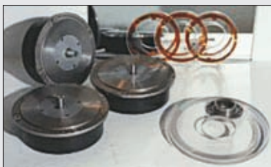
Рис. 4. Фотография радиальных дисков РГДР и голографических преобразователей угловых перемещений УПГ
