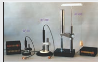
Рис. 5. Фотография длинномеров голографических с интерфейсно-дисплейными блоками управления: ДГ-30; ДГ-100; ДГ-200
