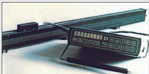
Рис. 3. Фотография голографического преобразователя линейных перемещений ЛПГ с интерфейсно-дисплейным блоком управления
