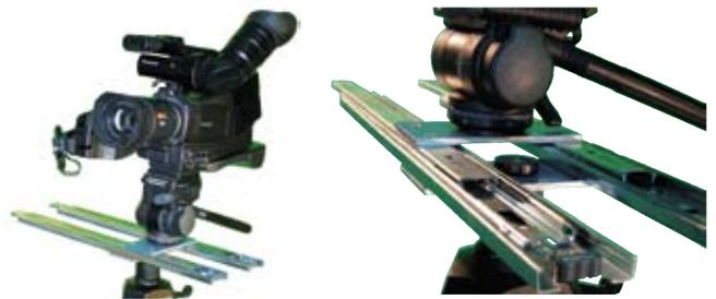
Рис. 2. Стереорельс для съёмки одной камерой
