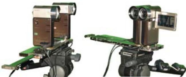
Рис. 1. Прецизионная платформа с камерами Sony HDR-TG 1E с афокальными насадками
