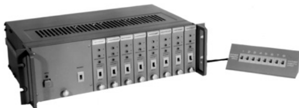
Рис. 5. 8-и канальная компандерная система шумопонижения
