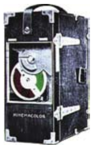
Кинокамера «Kinetacolor» с удалённой передней объективной панелью, за которой установлены на obtюраторе зелёный и красный светофильтры, через которые происходит цветная съёмка по системе «Kinetacolor»
