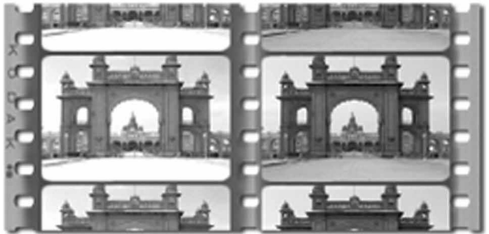
Двухцветный позитив на киноплёнке «Кодак» двойной ширины с центральной перфорацией для аддитивной цветной проекции по системе «Синехром» применялся с 1921 по 1925 год
