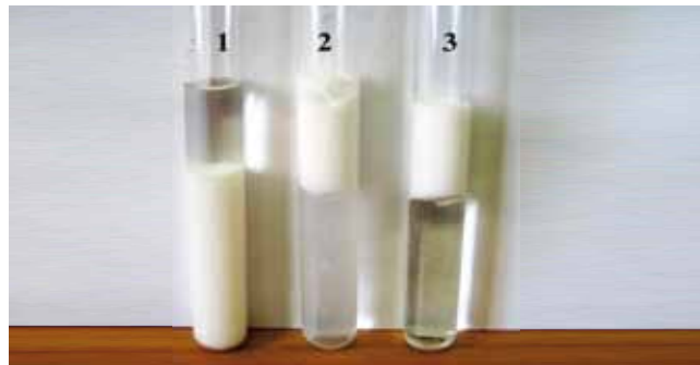
Рис. 4. Фотография систем водная дисперсия полистирольных микросфер-тетрадекан при различных концентрациях электролита, обеспечивающих различную устойчивость эмульсий первого типа
