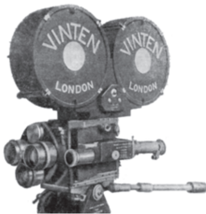
Кинокамера фирмы «Винтен» модель N с кассетой для «Бипака»
