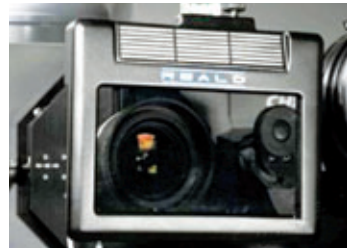
Рис. 6. Поляризующее устройство системы Real D
