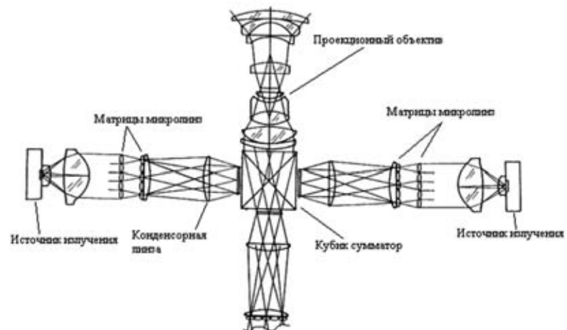
Рис. 4. Осветительная система с тремя LED источниками излучения и матрицами микролинз (для получения равномерной освещённости по полю)
