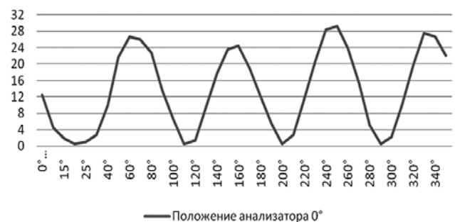
Рис. 7. Пропущенная мощность излучения при угле между поляризатором и анализатором, равном 0^\circ , в зависимости от угла поворота ПМС-ЖК
