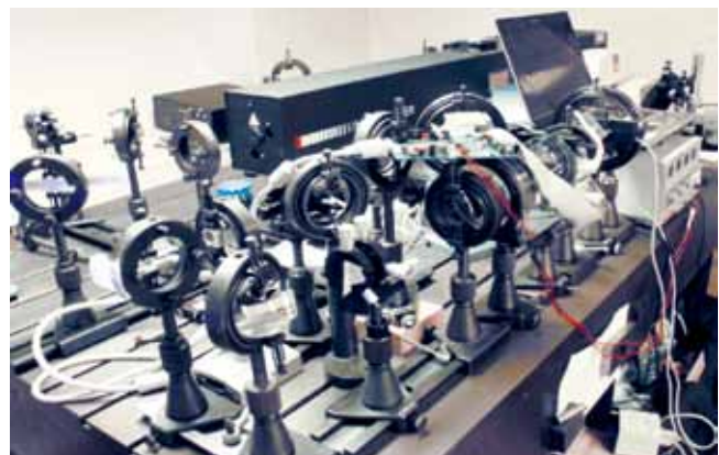
Рис. 9. Лабораторный стенд по исследованию фазовой модуляционной характеристики ПМС-ЖК
