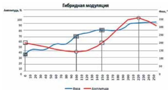
Рис. 20. Обобщённый график модуляционных характеристик для схемы параллельных модулятора и анализатора
