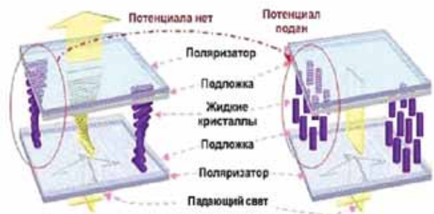
Рис. 2. Прохождение света через ячейку ПМС-ЖК
