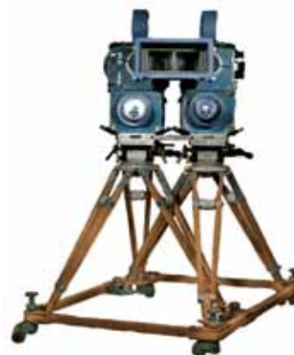
Рис. 1. Установка из двух киноаппаратов ЦКС-1 для цветной стереосъёмки
