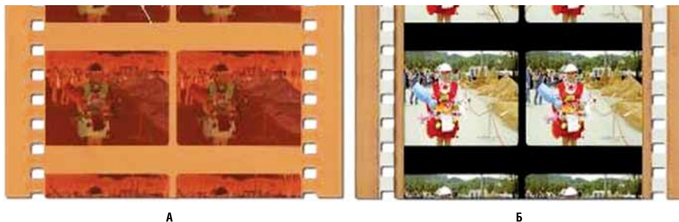
Рис. 41. Стереопара на 70-мм киноплёнке по советской системе «Сtereo-70»: А - негатив; Б - позитив с магнитной фонограммой
