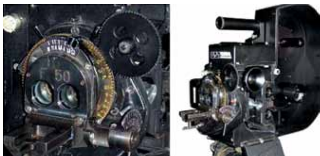
Рис. 40. 70 мм кинокамера с двухобъективным оптическим блоком по системе «Сtereo-70»
