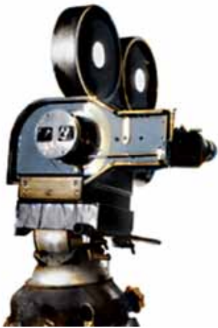
Рис. 30. Кинокамера ПСК-С для съёмки стереофильмов по системе «Сtereo-35, кадр над кадром»
