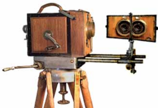
Рис. 14. Первый образец съёмочной двухзеркальной стереонасадки к камере «Debrrie L»
