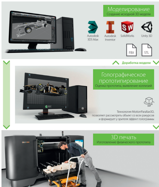
Рис. 1. Технологическая цепочка процесса моделирования и прототипирования: 1 – создание исходной 3D-модели с использованием известных пакетов САПР и моделирования; 2 – виртуальное прототипирование, при котором технология MotionParallax3D позволяет рассмотреть объект со всех ракурсов для всесторонней оценки прототипа, выявления коллизий, ошибок проектирования, возможностей доработки и пр.; 3 – изготовление физического прототипа методами 3D-печати
