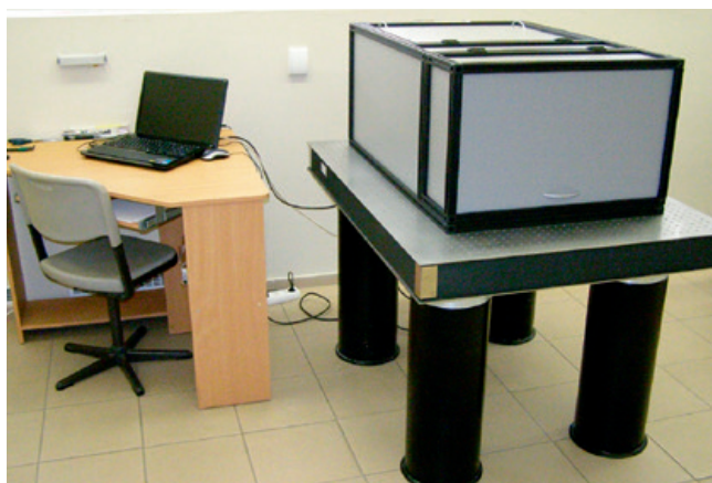
Рис. 8. Устройство для прямого получения мастер-голограмм DifX
