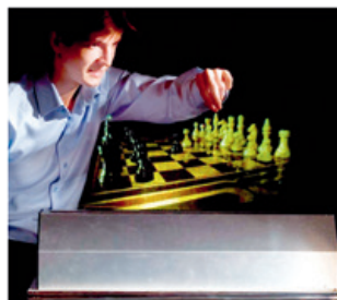
Рис. 5. Интерактивный дисплей российской разработки Displair с туманным экраном
