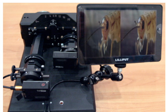
Рис. 3. Киноустановка для макростереосъёмки, вид сверху
