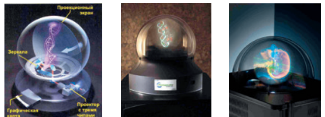
Рис. 28. Объемный дисплей Voxon Photonics с проекционной развёрткой на плоском экране
