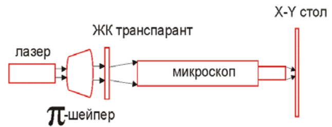
Рис. 14. Схема устройства «дот-матрикс»
