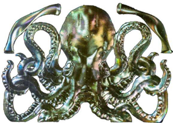
Рис. 5. Пример результата записи Лито. Реальная глубина рельефа – 0.3 мкм, кажущаяся – 4-5 мм
