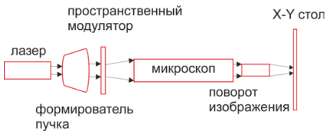
Рис. 17. Схема фреймового литографа
