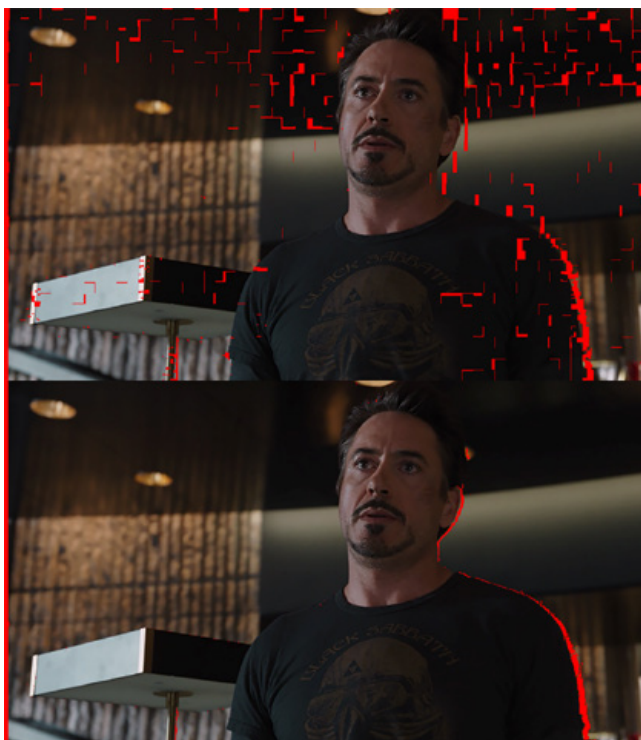
Рис. 1. Пример карты областей открытия (сверху), построенной по карте диспаратности без использования фильтрации [8], и карты областей открытия (снизу), построенной по карте диспаратности с использованием фильтрации [8]. Области открытия обозначены красным цветом. Применение фильтра [8] для фильтрации карт диспаратности помогает избавиться от большого числа ложноположительных срабатываний метода поиска областей открытия. Кадр из фильма «Мстители»
