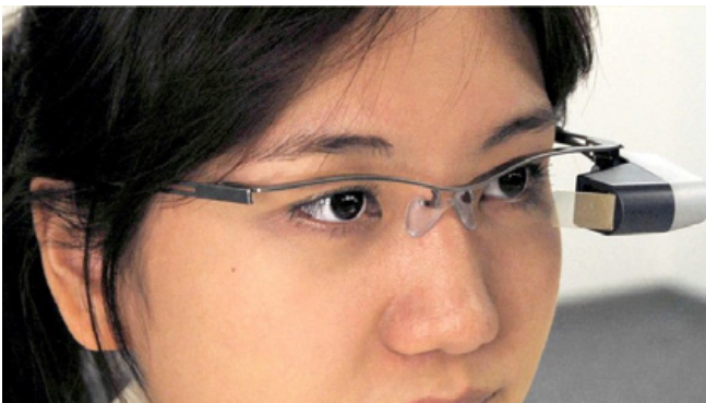
Рис. 5. Ретинальный дисплей, размещённый на оправе очков фирмы Brothers Industries, LTD (Япония)
