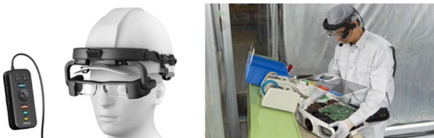
Рис. 10. Очки дополненной реальности с пультом управления Epson Moverio Pro BT и пример их применения
