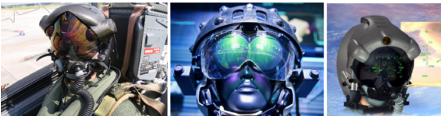
Рис. 13. Нашлемные системы целеуказания и индикации: система F-35 HMDS для самолёта истребителя Lockheed Martin F-35 («Локхид-Мартин» F-35 «Молния II»); российская бинокулярная система НСЦИ для боевых вертолётов Ми-28НМ «Охотник»; нашлемная система JHMCS (Joint Helmet Mounted Cueing System) компании Vision Systems International
