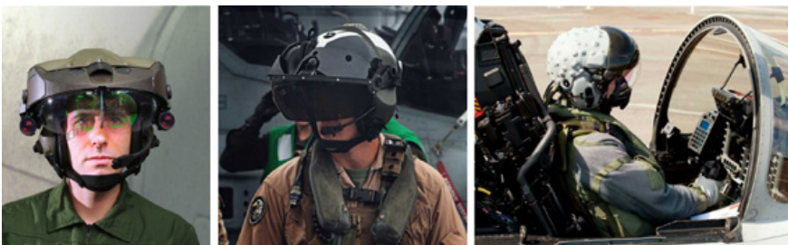
Рис. 12. Нашлемные системы целеуказания и индикации (helmet mounted display)
