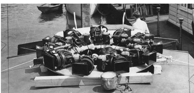
Установка из 11 кинокамер по системе «Circle-Vision 360»
