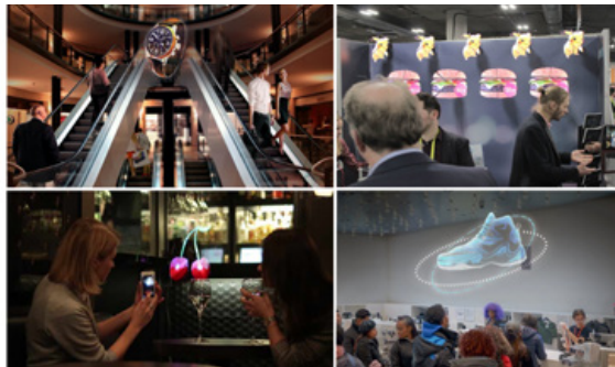
Рис. 18. Прозрачные экраны с вращающимися дискретными линейными элементами из светодиодных линеек фирмы Kino-mo: устройство Hypervsn и примеры инсталляции
