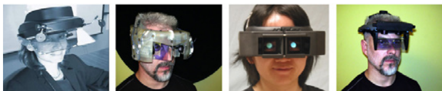
Рис. 8. Прототипы наголовных проекционных дисплеев ( head-mounted projective displays, HMPDs )
