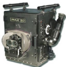
Стереокамера двухплёночная 70 мм формата, кадр 15 перф., вес с 120 метровой кассетой – 97 кг
