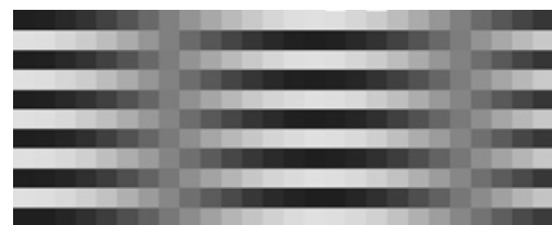
Рис. 6. Муар при повороте направления изменения освещённости в оптическом изображении относительно горизонтальных рядов пикселей матрицы
