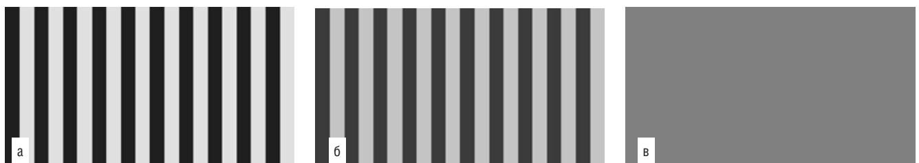
Рис. 4. Дискретное изображение E^* , когда пространственная частота освещённости в оптическом изображении f_x = 50 \text{ мм}^{-1} и фаза оптического изображения: а) \varphi=0 ; б) \varphi = \frac{\pi}{4} ; в) \varphi = \frac{\pi}{2}
