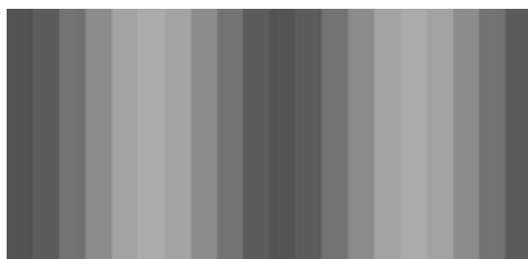
Рис. 5. Дискретное изображение E^* с ложной пространственной частотой f_x^* = -10 \text{ мм}^{-1}
