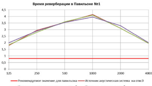
Рис. 10. Частотная характеристика времени реверберации, измеренная в павильоне № 1
