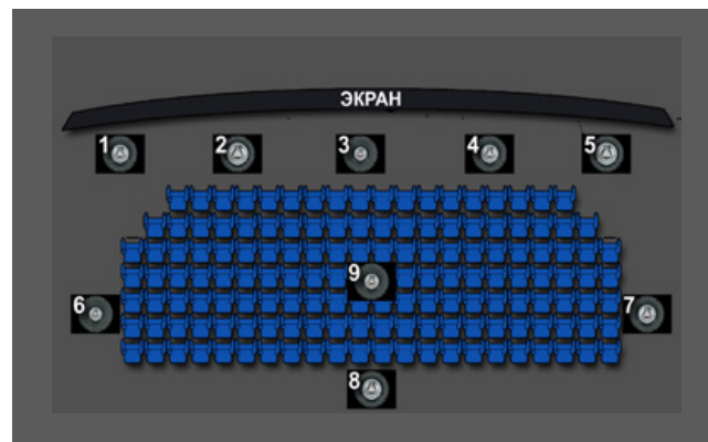
Расположение динамиков в зале для девятиканального стереофонического звукового сопровождения
