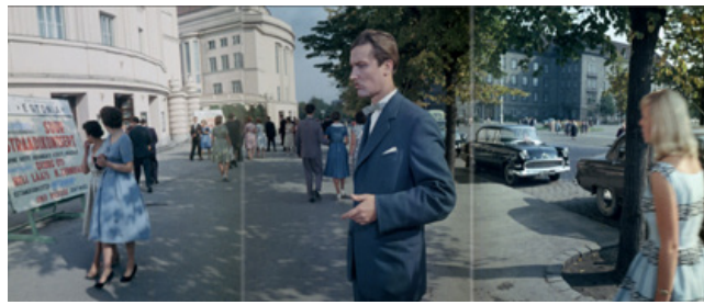
Белые полосы на стыках кадров при проекции позитивов, напечатанных без оптического клина
