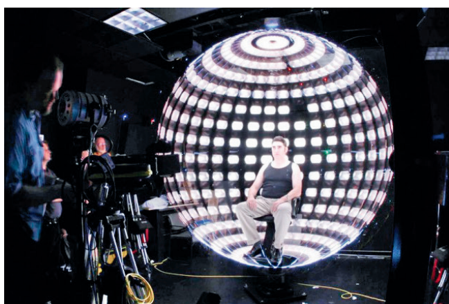
Рис. 4. На съёмках кинофильма «Человек-паук 2» (Spider-Man 2). Показан процесс 3D-сканирования актёра Альфреда Молины системой Light Stage 2 [9]
