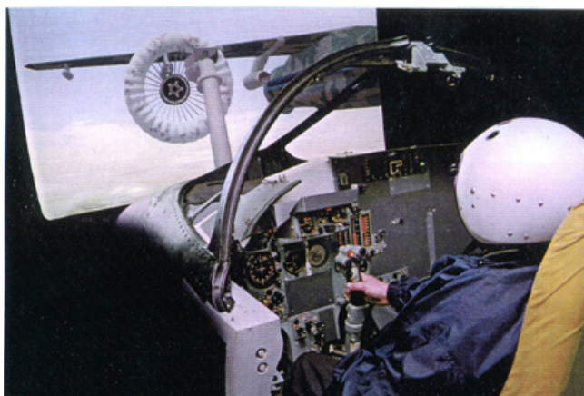
Однопilotный тренажёр дозаправки топливом в воздухе
