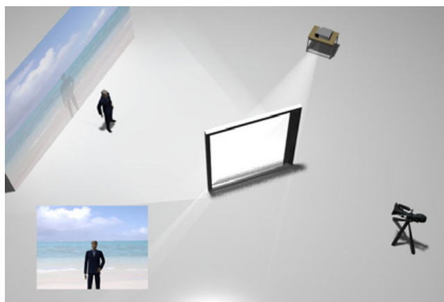
Рис. 2. Схема Фронт проекции
