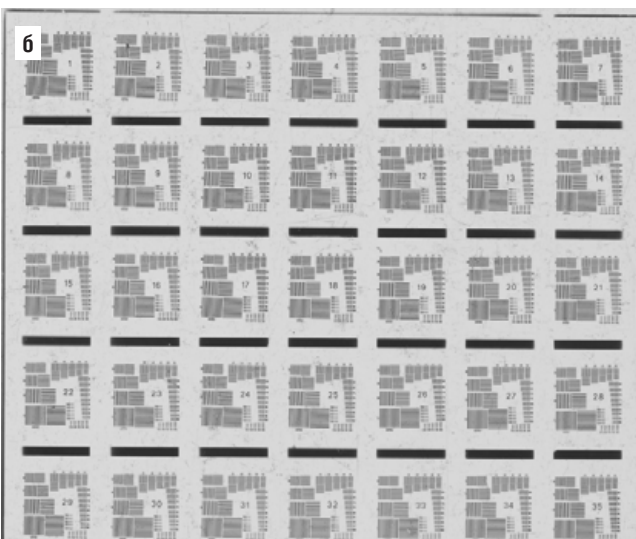
Рис. 4. Тестовые изображения, использованные для анализа разрешения: а) 35КФИ-А, б) Vuzort
