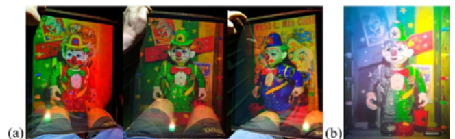
Рис. 10. Трёхактурная (а) и чёрно-белая/цветная (b) голограмма, напечатанная на голографическом принтере Chimera
