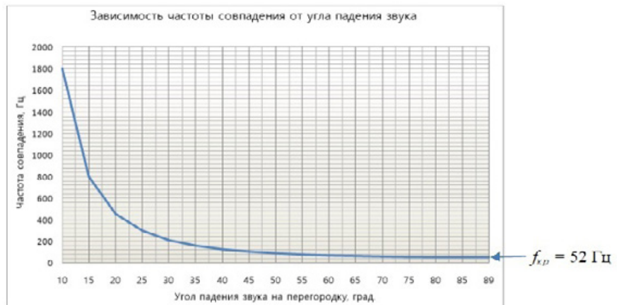
Рис. 2. Зависимость частоты совпадения f_c от угла падения \theta звуковой волны на перегородку из бетона толщиной h = 300 мм
