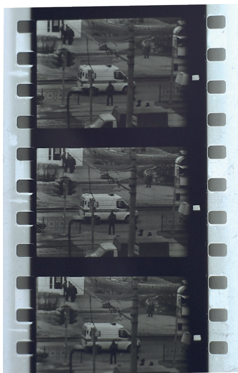
Илл. 9. Фрагмент экспериментального ролика системы КВК-М на тонкой неперфорированной киноплёнке (позитив, отпечатанный с перфорированного негатива)
