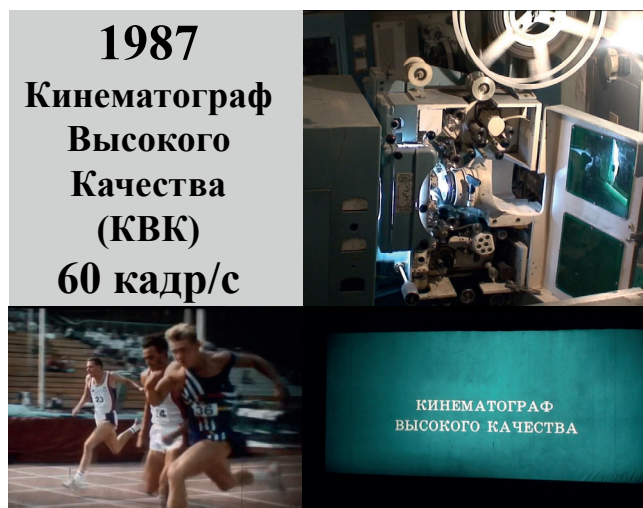
Илл. 8. Установка на базе кинопроектора КП-30 для показа экспериментальных роликов системы КВК и кадры из роликов
