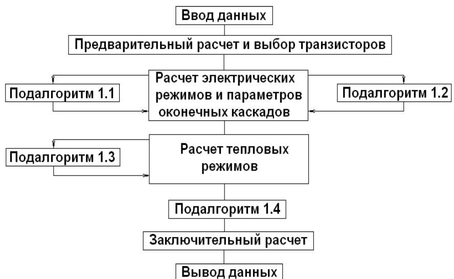
Рис. 2.2. Обобщенная структура алгоритма расчета
