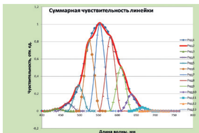
Рис. 9. Приведение спектральной чувствительности фотодиодной линейки к виду относительной световой эффективности глаза V(\lambda)
