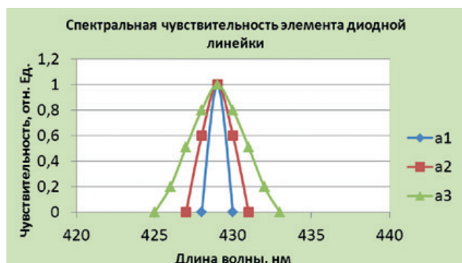
Рис. 7. Относительная спектральная чувствительность элемента фотодиодной линейки при различных значениях ширины аппаратной функции a_1 , a_2 , a_3
