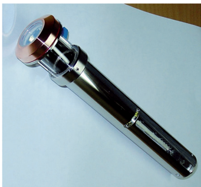
Рис. 9. Промышленный образец оконечного лазерного биомедицинского устройства, содержащего 3D объектив переменного увеличения
