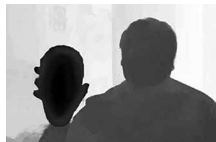
Рис. 3. Несжатая карта глубины, полученная с помощью Microsoft Kinect. Чем темнее область, тем ближе она находится
