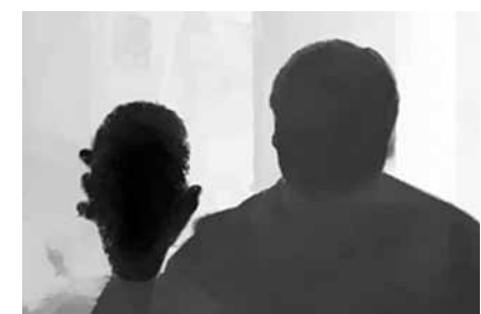
Рис. 5. Карта глубины, сжатая с использованием распространения глубины ключевых кадров уменьшенного разрешения
