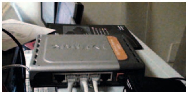
Рис. 8. Подключение трёх компьютеров коммутатором D-Link DES-1005D
