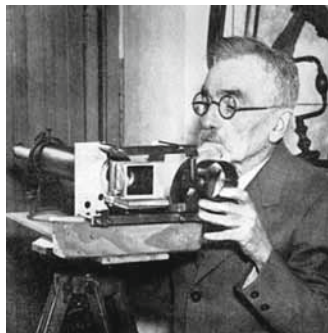
Анри Кретьен демонстрирует анаморфотную оптическую систему «Нупергонар»
