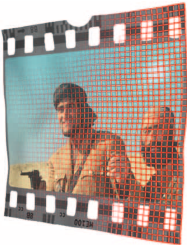
Рис. 1. Условное представление деформации кадра на плёночном носителе
