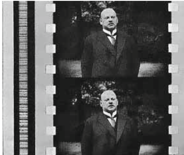
Кадр из 42-мм позитивной копии с оптической фонограммой переменной плотности по системе «Три-Эргон»
