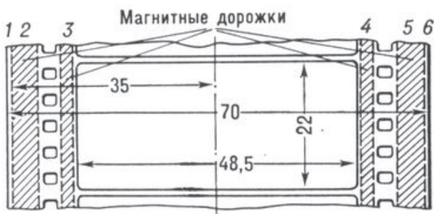
Фото 2. Формат 5-перфорационного кадра на 70-мм плёнке (5/70)
