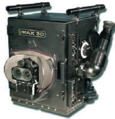
Стереокамера двухплёночная 70 мм формата, кадр 15 перф. вес с 120 метровой кассетой – 97 кг.
