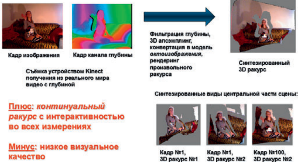
Рис. 6. Практический результат: видео с каналом глубины, снятое устройством Kinect [2], модель – октоизображение, полученное с использованием алгоритмов фильтрации и апсэмплинга
