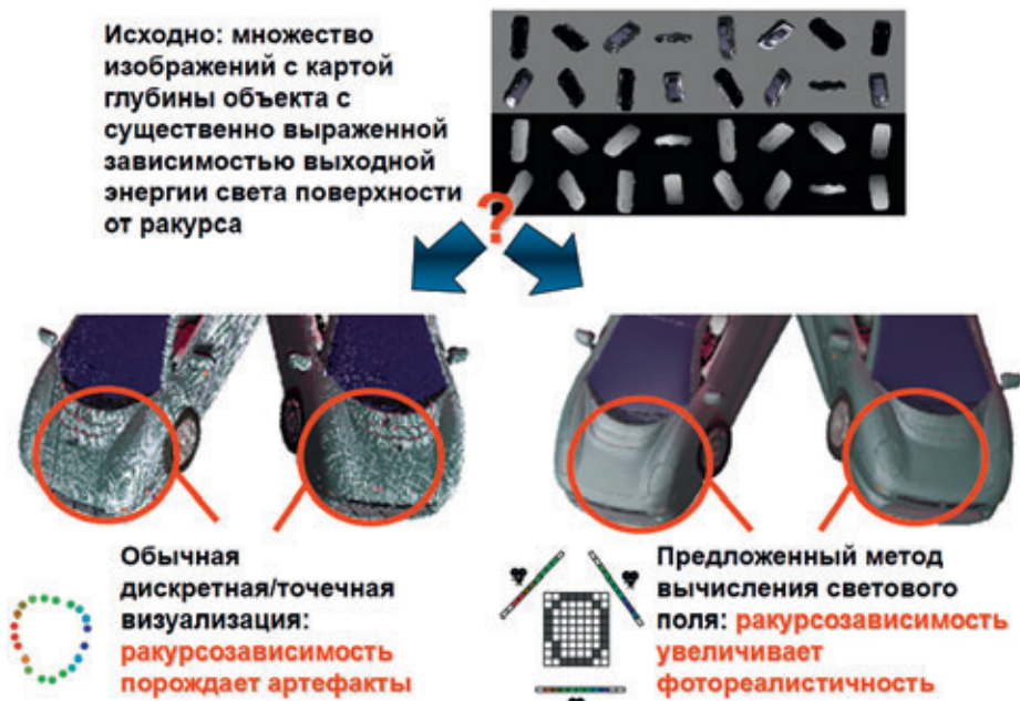
Рис. 4. Предложенный метод вычисления светового поля по сравнению с обычной точечной визуализацией в случае существенной ракурсообразности цвета поверхности
