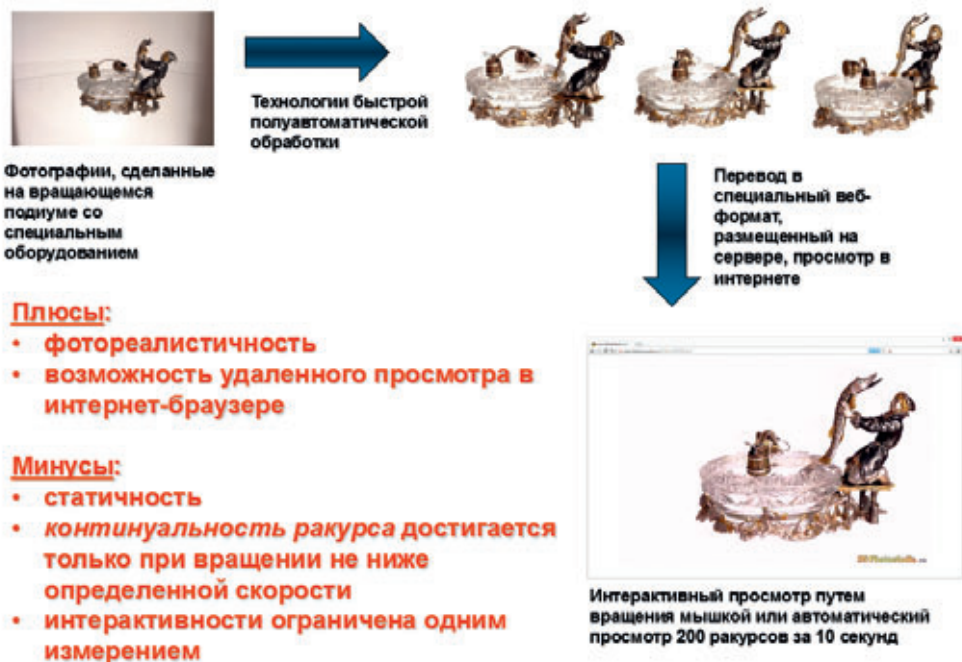
Рис. 8. Практический результат: многоракурсное/3D фото с 200 ракурсами, снято методом вращения объекта с последующим полуавтоматическим удалением фона
