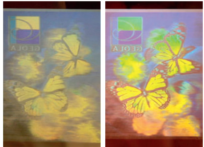
Рис. 9. Никелевая матрица радужной псевдоцветной (true-color) голограммы «Бабочки», изготовленная ОАО НПО «Криптен» с мастер-оригинала Геолы: слева – восстановление изображения с использованием протяжённого диффузного источника света; справа – восстановление изображения с использованием точечного направленного источника света
