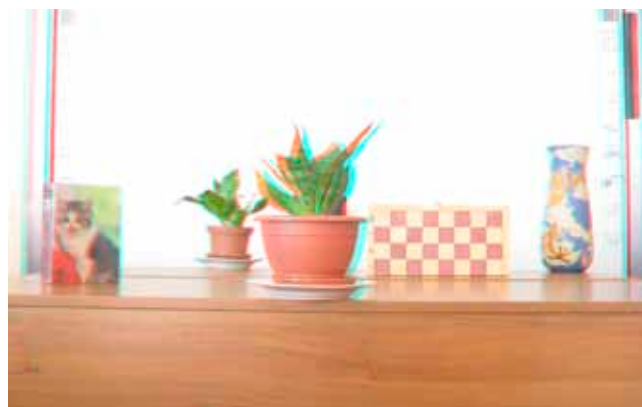
Рис. 21. Анаглифное изображение, автоматически сформированное цифровой конвергенцией по выбранному объекту (шахматной доске)
