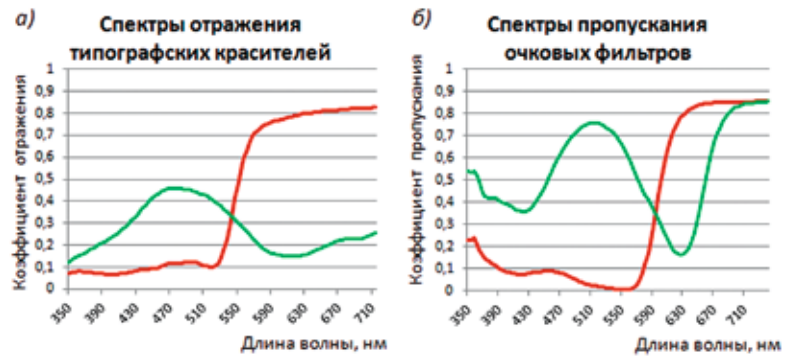
Рис. 4. Спектральные кривые красителей, использованных в стереограммах Юлеша для левых и правых изображений (а), и цветных фильтров (б) в очках, прилагаемых к книге [6]
