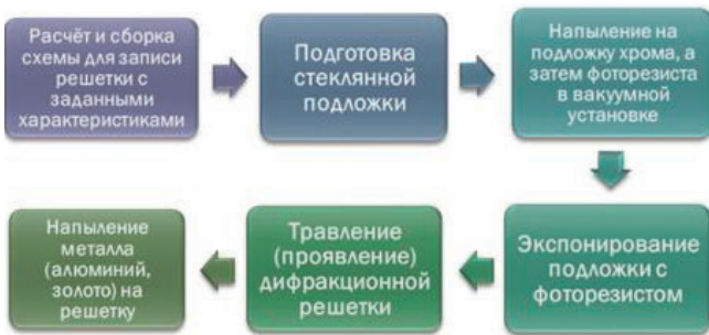
Рис. 4. Блок-схема изготовления голограммной дифракционной решётки
