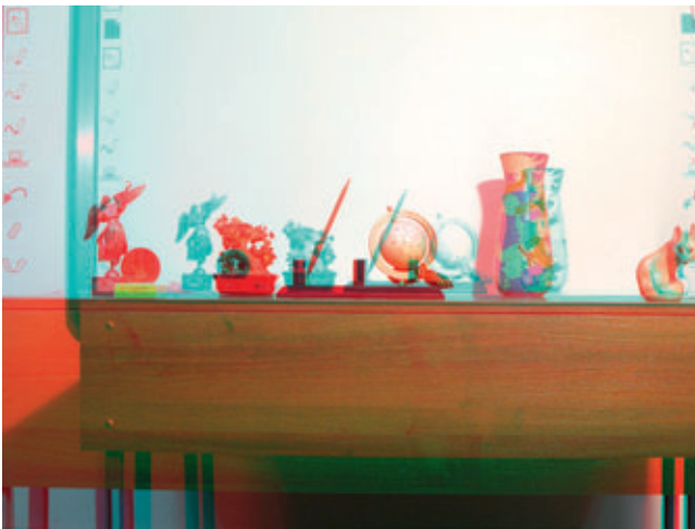
Рис. 2. Анаглифное изображение, образованное наложением левого и правого кадров стереопары без коррекции разномасштабности изображений
