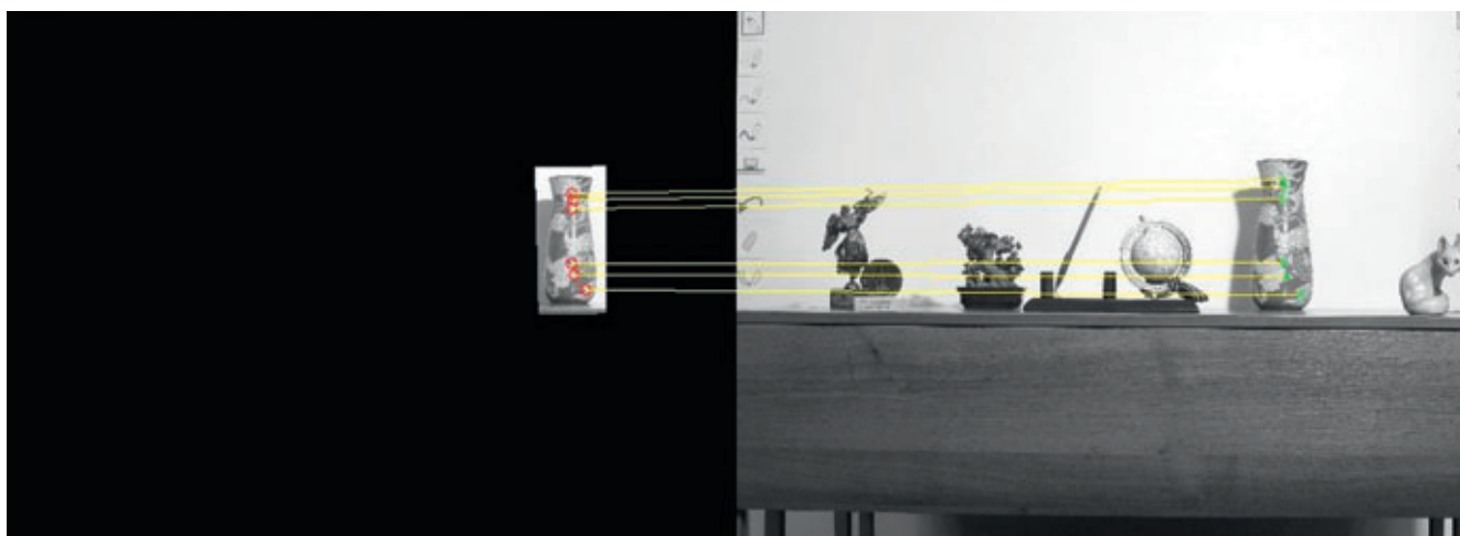
Рис. 11. Ключевые точки полутонового изображения выделенного объекта на левом кадре, сопряжённые с ключевыми точками полутонового изображения правого кадра стереопары
