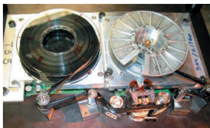
Рис. 2. Макет считывающего тракта системы LTO.
