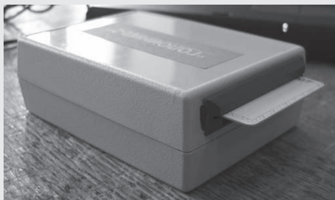
Рис. 1б. Фотография оптико-электронного прибора считывания микроизображений для идентификации защитных голограмм
