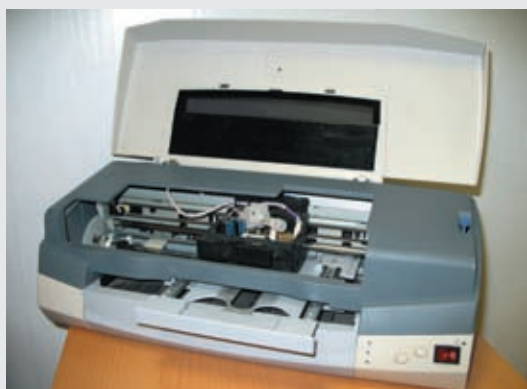
Рис. 1а. Фотография лазерного микроперфоратора для индивидуализации защитных голограмм
