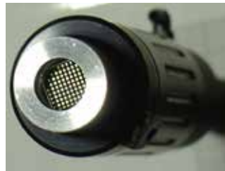
Рис. 8. Основной узел регистрации пространственной структуры светового поля для решения некоторых задач микроскопии.
