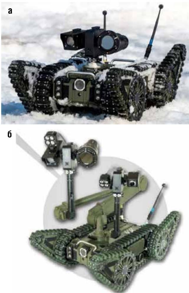
Рис. 1. Мобильный робот «Капитан» [14]: а) базовая модификация робота, б) модификация робота с многостепенным манипулятором
