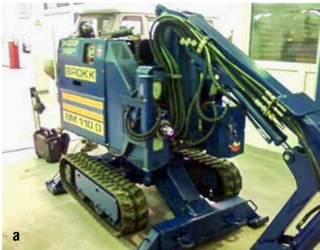
Рис. 4. Робототехнические комплексы семейства BROKK: а) комплекс BROKK-110D, б) комплекс BROKK-330
