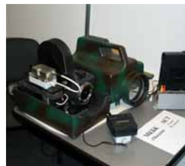
Бокс для передвижных подводных съемок (МКБК)
