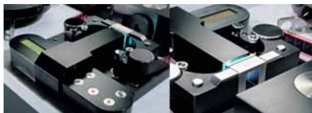
Рис. 2. Узлы фильмосканера Northlight: фильмовый канал и панель управления
