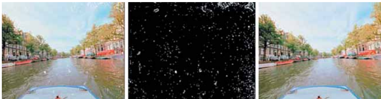
Рис. 7. Применение технологии KODAK Digital ICE для удаления грязи и царапин с изображения (исходный кадр, карта дефектов, исправленный кадр)
