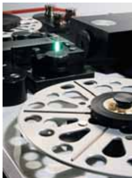
Рис. 3. Сканирование 16-мм фильмокопии
