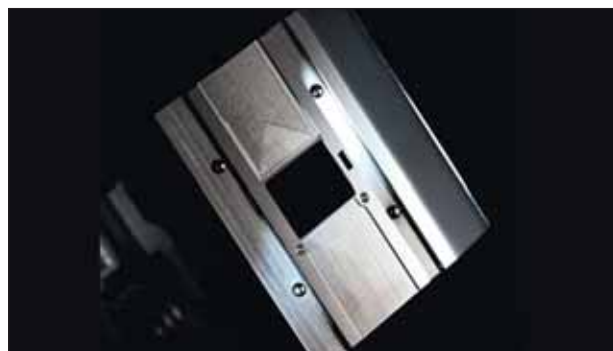
Рис. 8. Сменный 35-мм фильмовый канал
